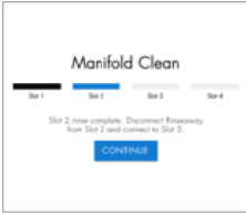
عند اكتمال الشطف، إفصل زجاجة شطف الجهاز من الفتحة رقم ١ وو صلها بالفتحة رقم ٢. ثم اختر "متابعة"
