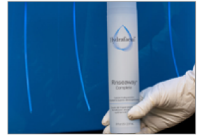
عند اكتمال الشطف، إفصل زجاجة شطف الجهاز من الفتحة رقم ٢ وو صلها بالفتحة رقم ٣. ثم اختر "متابعة"
