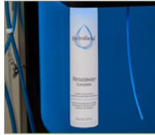
أدخل زجاجة شطف الجهاز في الفتحة رقم ١. ثم اختر "ابدأ الشطف"
